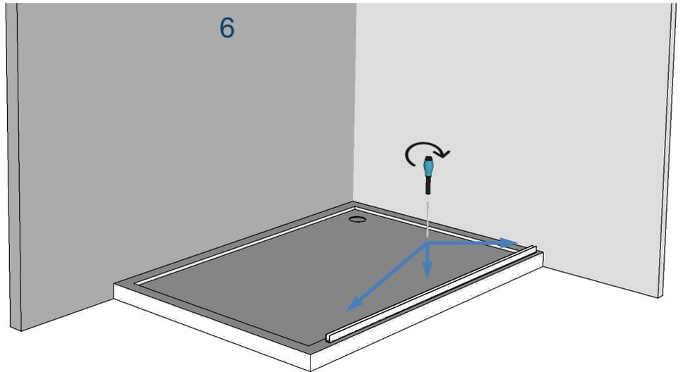
5 - Déposer un cordon de silicone sous le profilé + dans les trous
