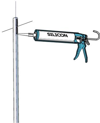
5 - Déposer un cordon de silicone sous le profilé + dans les trous
