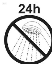
3 - Siliconer le verre dans les profils en U, intérieur et extérieur. Laisser sécher 24H
